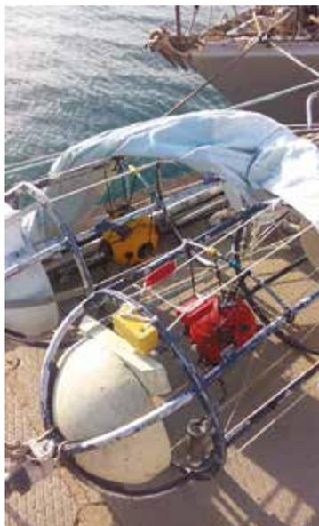
Рис. 3. Комбинированные четырехканальные приемные модули без обтекателя на борту НИС перед постановкой. Залив Петра Великого. 2008 г.
