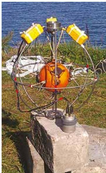
Рис. 2. Акустический низкочастотный четырехкомпонентный комбинированный приемник в корзине обтекателя. Векторный приемник (сфера) – трехкомпонентный приемник градиента давления. Диапазон рабочих частот 10–1000 Гц. Чувствительность приемника давления 500 мкВ/Па. Осевая чувствительность векторного канала 1200 мкВ/Па на частоте 1000 Гц.
