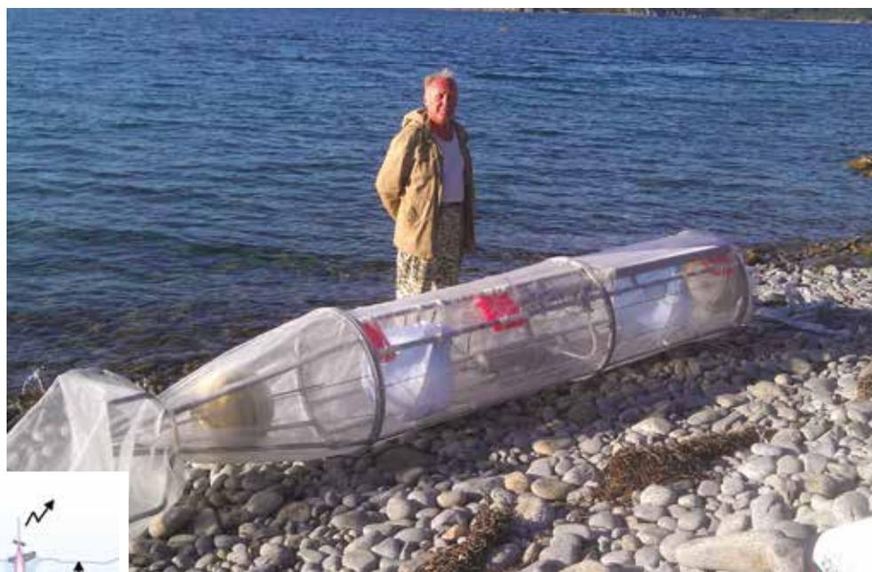
Рис. 6. Восьмиканальный комбинированный приемный модуль в обтекателе. Один из приемных элементов акустического интерферометра интенсивности (аналог оптического интерферометра Юнга–Релея). Бух. Витязь. 2013 г.
