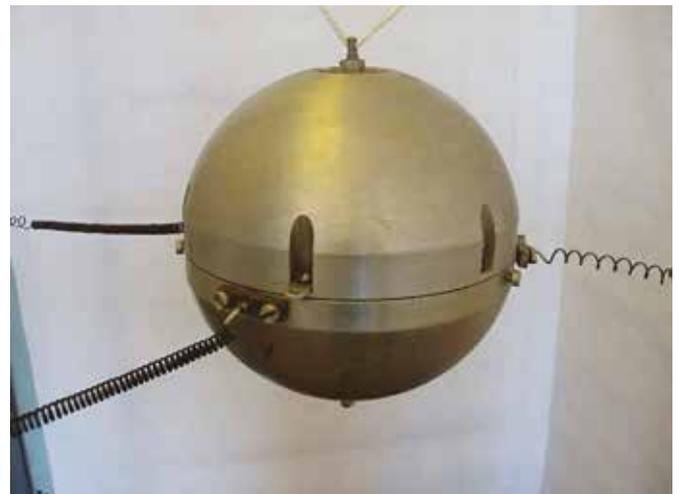
Рис. 1. Электродинамический низкочастотный трехкомпонентный векторный приемник. Максимальная глубина погружения 1000 м. Рабочий диапазон 1–100 Гц. Осевая чувствительность каналов 10 мкВ/Па
